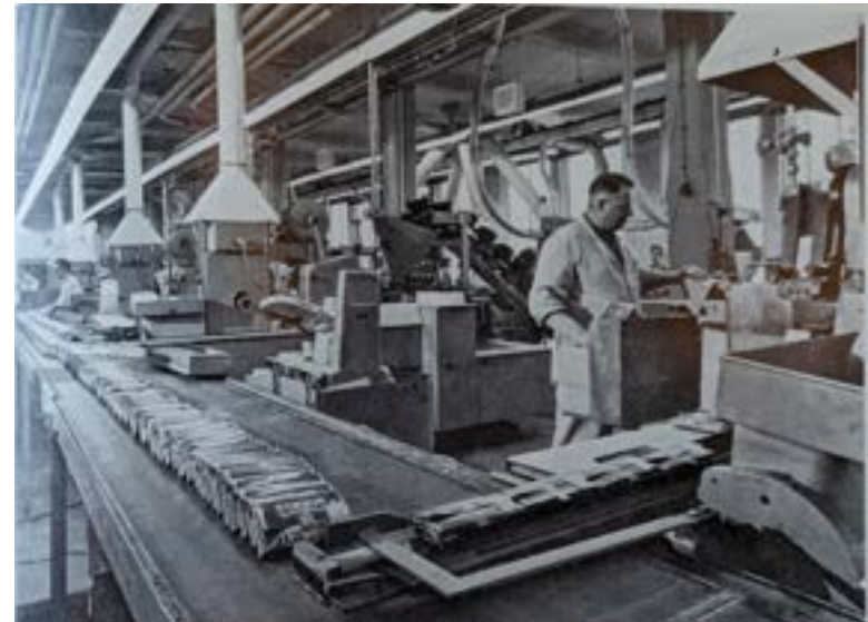
afbeelding 390. Batterij van de sigarettenmaakmachines, goed voor de productie van 1600-2000 sigaretten per minuut.
